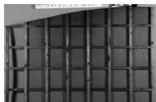
図8 一部のパーティクルボードを外した(裏)
