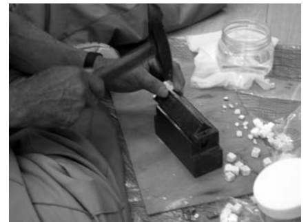
図10 充填用テッセラの石割り
