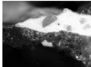
図3 試料片 人物像 鉛白に方解石とケイ素塩化合物の 粒子が混在している。
