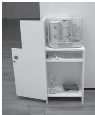
図6 温湿度計設置台の内部
