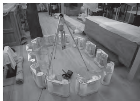
図1 アスマン計による毛髪計の調整
