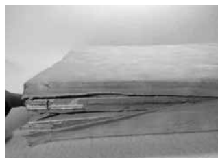
5. 綴じ糸が切れ、折り丁同士の接続が外れている
