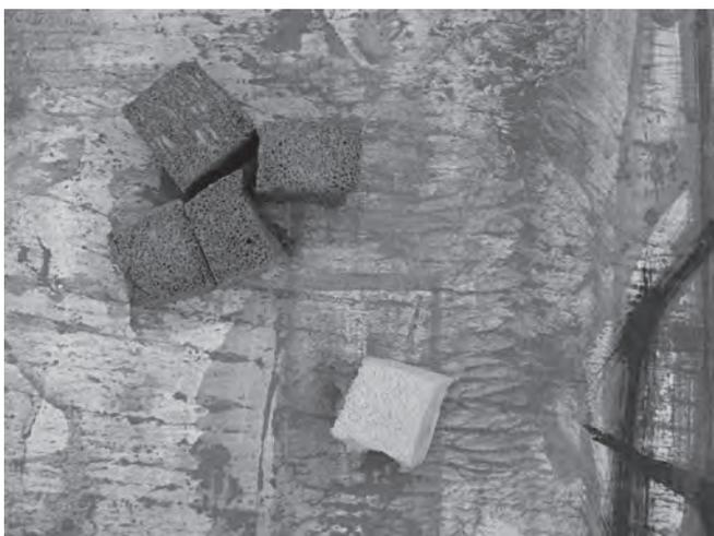
図3. 修復中 ドライクリーニング(ケミカルスポンジ使用前後)
